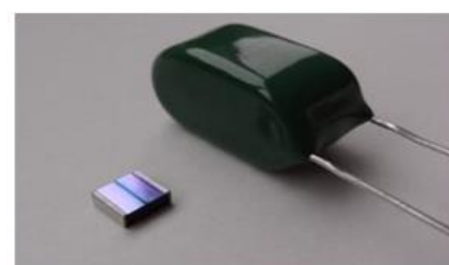
フィルムコンデンサとのサイズ比較例 10 \mu\text{F}
